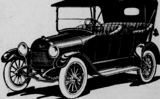
30 Pferdekraft-Motor, 12 Volt-Batterie, Selbst-Starter, Generator
