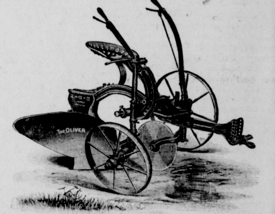
Außer dem alten „Casady“ haben wir auch einen neuen Drei-Rad-Pflug, welcher einfach und dauerhaft ist. Dieser Pflug zieht sich besonders leicht dadurch, daß der Zug direkt vor der Schare ist. Außer den obigen Pflügen haben wir eine große Auswahl
